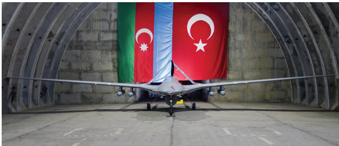
پهپاد رزمی بیرق‌دار تی.بی.۲ ترکیه با بمب‌های هدایت‌شونده لیزری مام-ال (MAM-L). منبع: اوریکس
