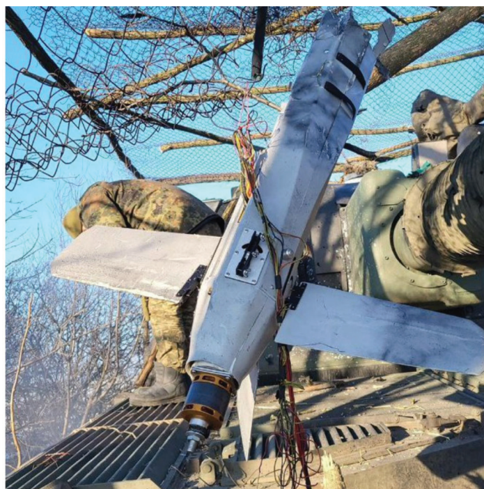
بقایای یک پهپاد انتحاری لنست روسی در اوکراین که توانست به حصار توری محافظ اطراف یک توپ خودکشی هویتزر نفوذ کند و پیش از موقع منفجر شد. منبع: کریگسفورشر
