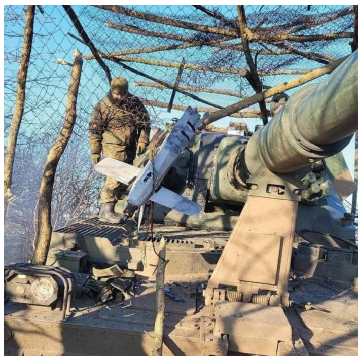
بقایای یک پهپاد انتحاری لنست روسی در اوکراین که توانست به حصار توری محافظ اطراف یک توپ خودکشی هویتزر نفوذ کند و پیش از موقع منفجر شد. منبع: کریگسفورشر
