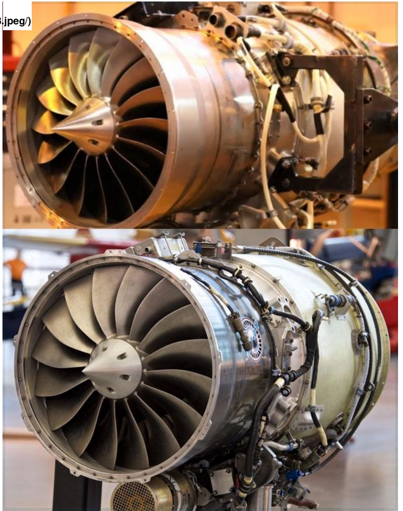
موتور جهش-۷۰۰ ایران (بالا) ظاهرا یک کپی از موتور آمریکایی ویلیامز اف-۱۳۳/اف-۴۴ (پایین) است (منابع TEM : ویلیامز اینترنشنال)
